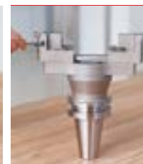
После регулировки зафиксируйте зажимной винт
