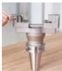
Ослабьте зажимной винт корпуса расточки
